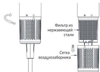
Фильтр необходимо регулярно чистить и обслуживать, чтобы избежать засорения мусором и обеспечить бесперебойную подачу воздуха. Чтобы снять сетку-фильтр воздухозаборника-крепко возьмитесь за ручку, поверните сетку в соответствии с отметкой на хвостовой части ручки и снимите её.
