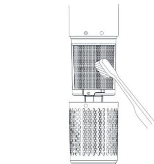
Не мойте фильтр из нержавеющей стали водой, иначе это может привести к неисправности. Используйте сухую безворсовую ткань, мягкую щётку, и другие инструменты для удаления загрязнений на поверхности сетки воздухозаборника и фильтра из нержавеющей стали.
